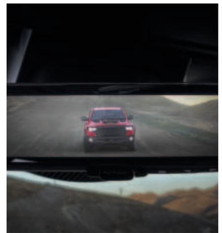
Der herkömmliche Spiegel wird durch ein digitales Display ergänzt, das einen besseren Blick auf den Bereich hinter dem Fahrzeug ermöglicht.
