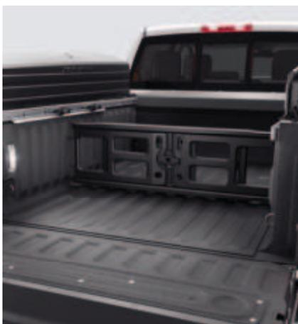
Beinhaltet ein Laderaum-Schienensystem mit vier verstellbaren Verzurrösen, eine ausfahrbare Trittstufe und einen aufgespritzten Laderaumschutz, der einen nahtlosen, dauerhaften Schutz mit einem speziellen Finish bietet und Widerstandsfähigkeit der Ladefläche maximiert. Die Modelle mit Rambox sind mit einem Ladeflächentrenner ausgestattet.
