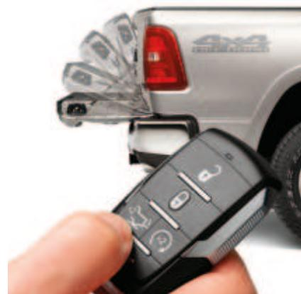
Die neue elektrische Heckklappe schließt jetzt auch auf Ihr Kommando (Verfügbarkeit prüfen; nicht erhältlich mit der Multifunktions-Heckklappe) über den Schlüssel, der auch die Türen, die RamBox®-Schlösser, den Luftfederungsmodus (ausstattungsabhängig) und den Fernstart zum Aufwärmen des Motors und Öffnen der Heckklappe steuert.
